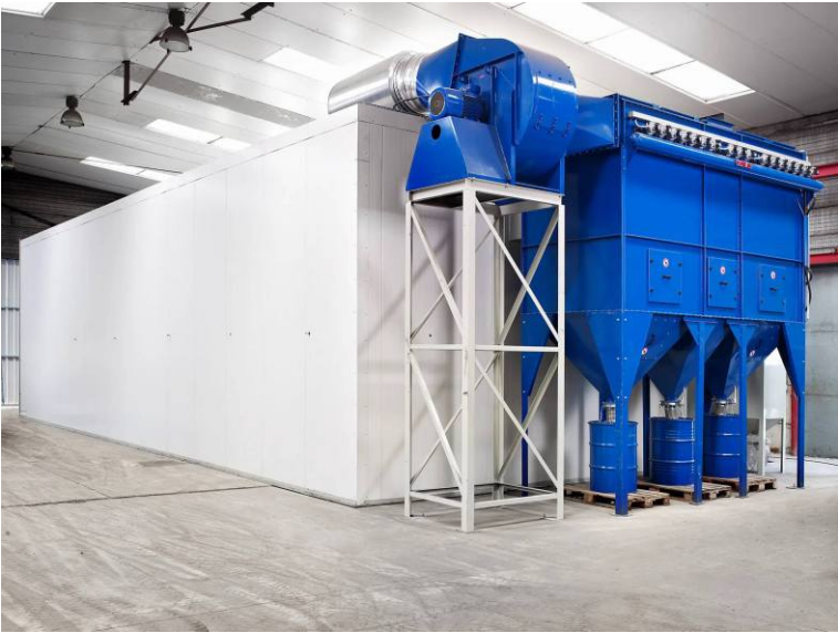
Фільтрувальна установка ФУ-32
