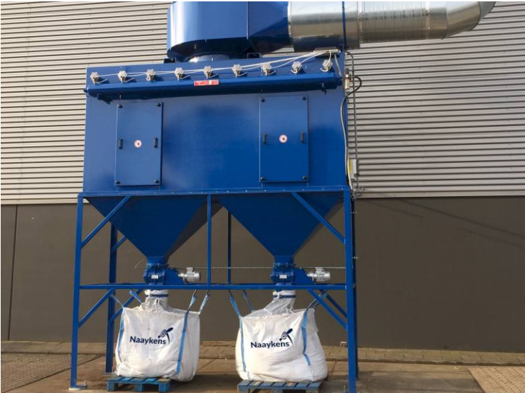
Фильтровальная установка ФУ-16
