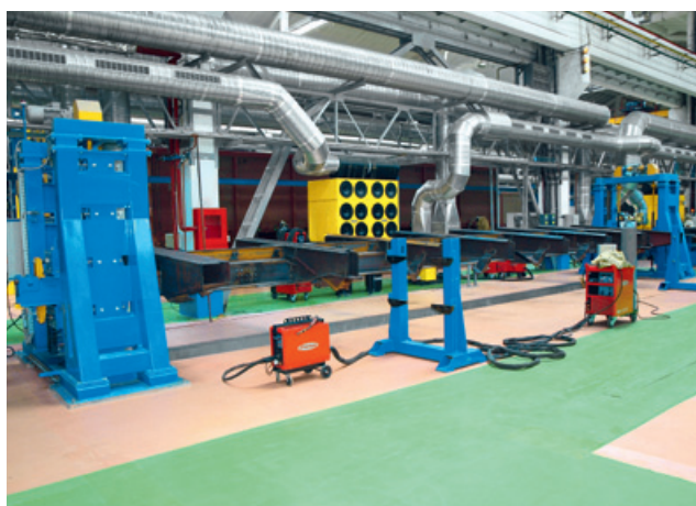
Кантователь с подъёмными центрами грузоподъёмностью 15 т
