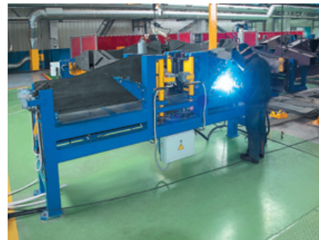
Стенд сборки промежуточных балок
