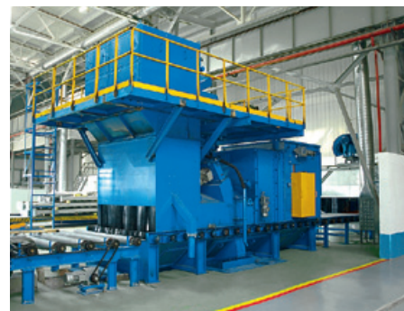
Дробеметная камера для очистки металлопроката
