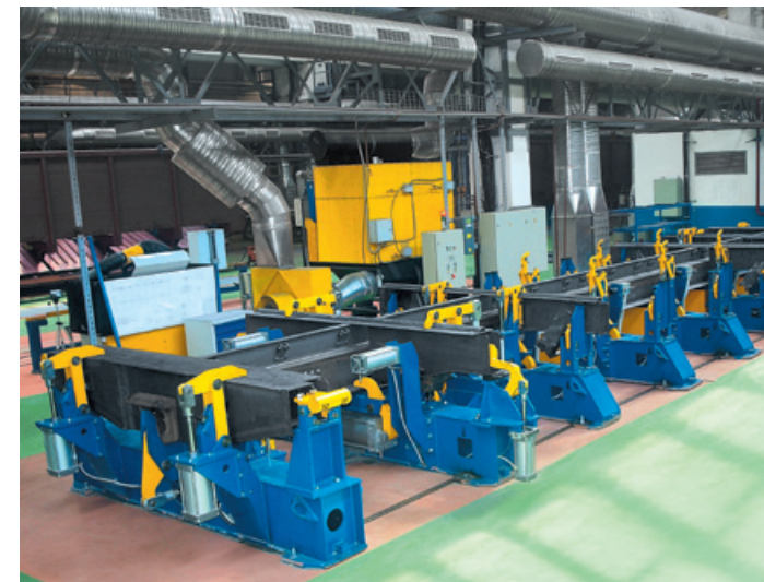
Стенд сборки и сварки рам полувагонов
