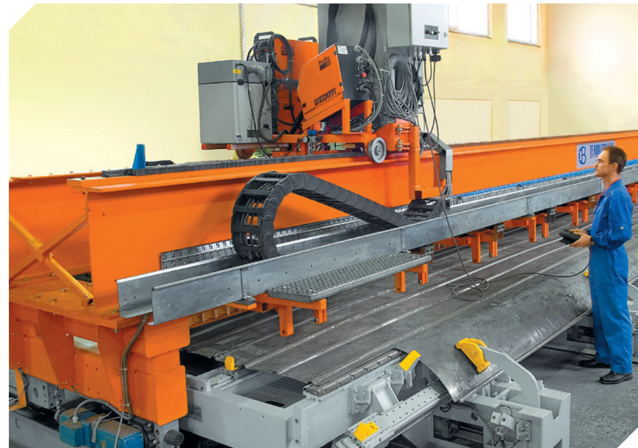
Универсальный стенд сборки и сварки крыш пассажирских вагонов
