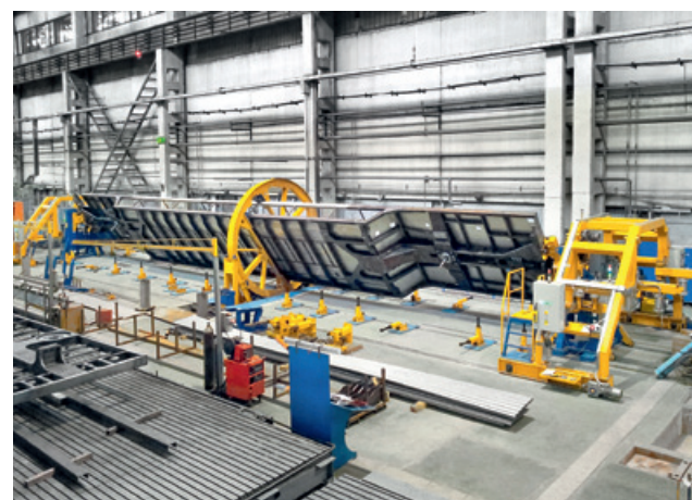
Стенд-кантователь с подъёмными центрами и поддерживающим кольцом (для длинных и нежёстких изделий)
