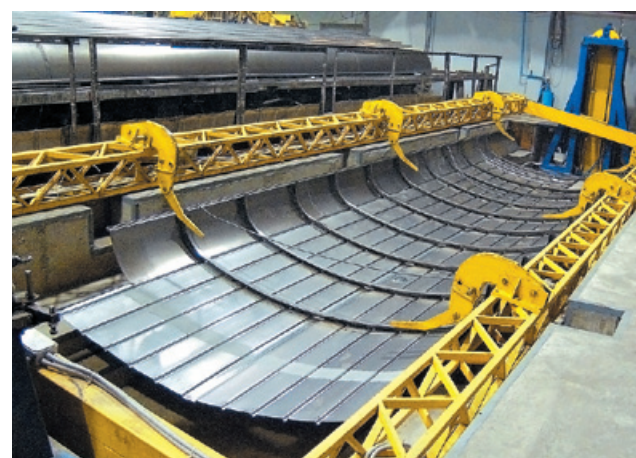
Кантователь сварки обшивки крыши вагонов
