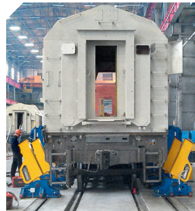
Передвижные домкратные установки для локомотивов
