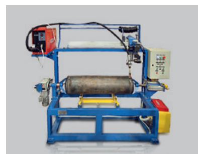
Стенд автоматической сварки донышек с обечайкой
