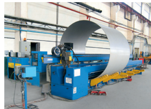
Стенд сварки обечаяек
