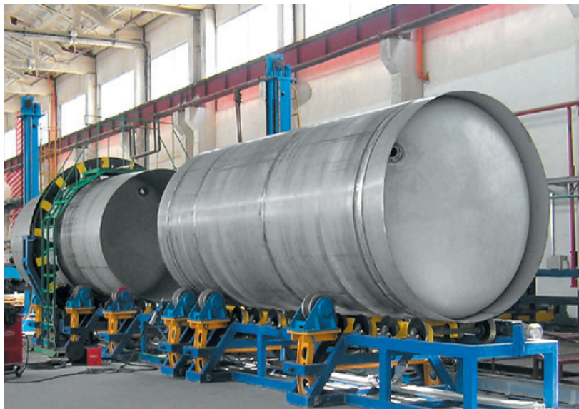
Линия сборки и сварки котла
