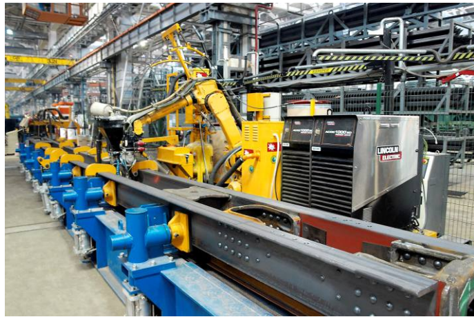
Роботизированный комплекс сварки хребтовых балок грузовых вагонов
