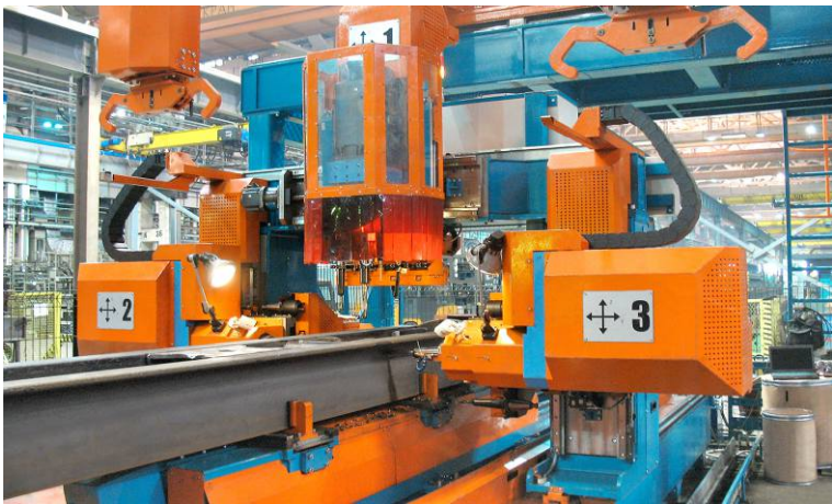
Автоматизированный комплекс сверловки хребтовых балок грузовых вагонов (сверлильный портал)
