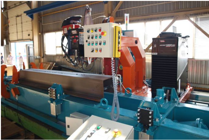
Стенд автоматической сварки хребтовых балок вагонов-цистерн
