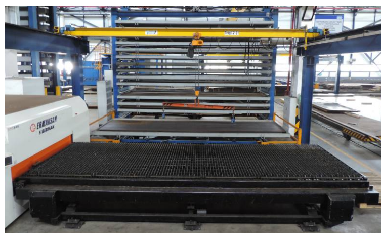
Автоматизированный склад листового металлопроката
