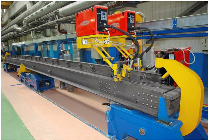
Стенд автоматической сварки хребтовой балки с двутавром
