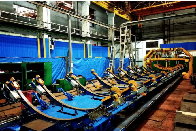
Универсальный стенд сборки и сварки крыши вагонов-хопперов
