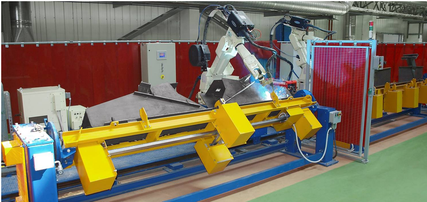
Роботизированный комплекс для сварки перечных балок
