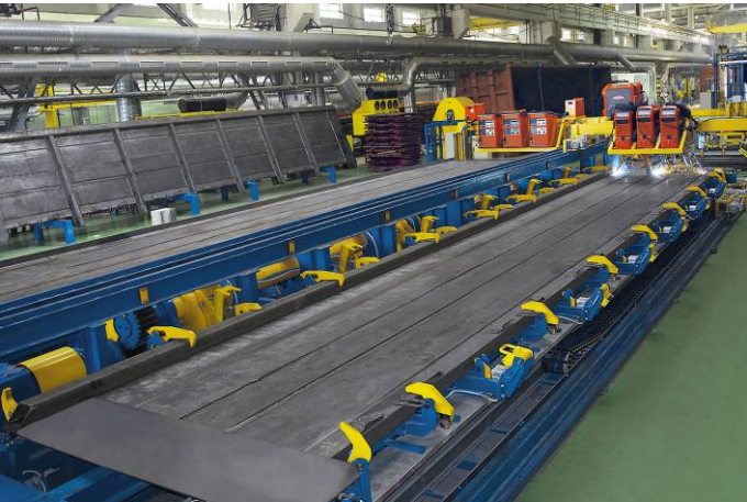
Стенд сварки боковых стен полувагонов
