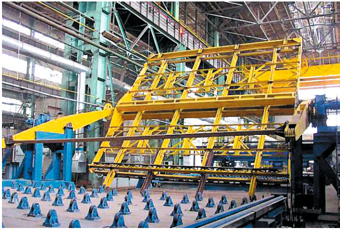
Стенд сварки полотнищ
