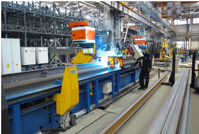
Стенд автоматической сварки хребтовой балки с двутавром
