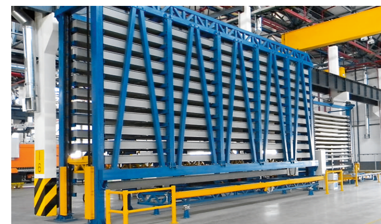
Автоматизированный склад профильного металлопроката
