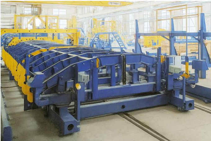
Стенд сборки и сварки крыши вагонов-хопперов
