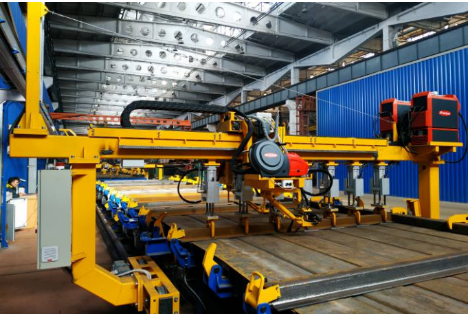
Стенд сварки боковых стен полувагонов
