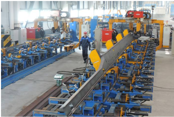
Стенд автоматической сварки двутавровых балок переменного сечения
