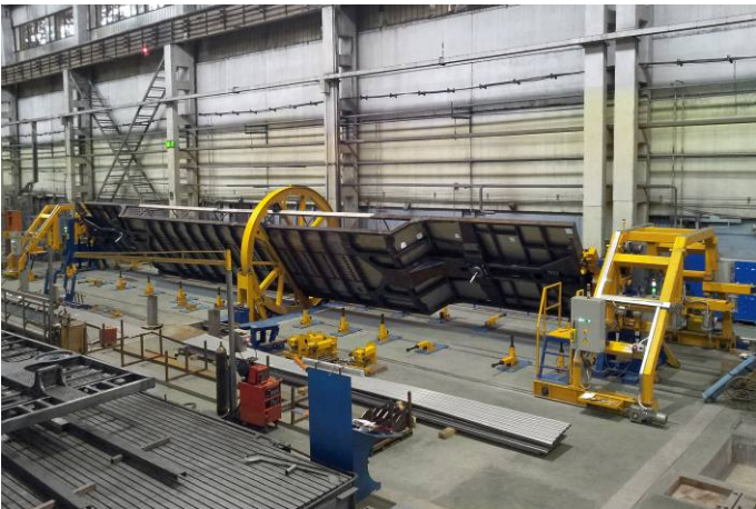
Стенд-кантователь для приварки настила пола и монтажа подвагонного оборудования
