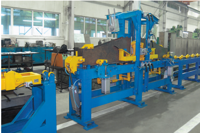
Линия сборки, сварки шкворневых балок
