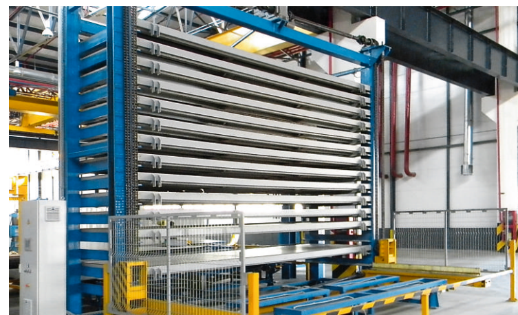
Автоматизированный склад листового металлопроката
