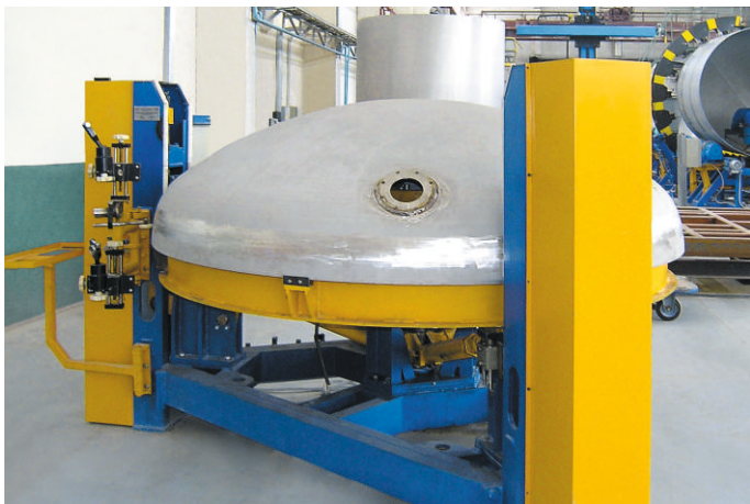
Стенд сборки, сварки днищ котла и торцовки
