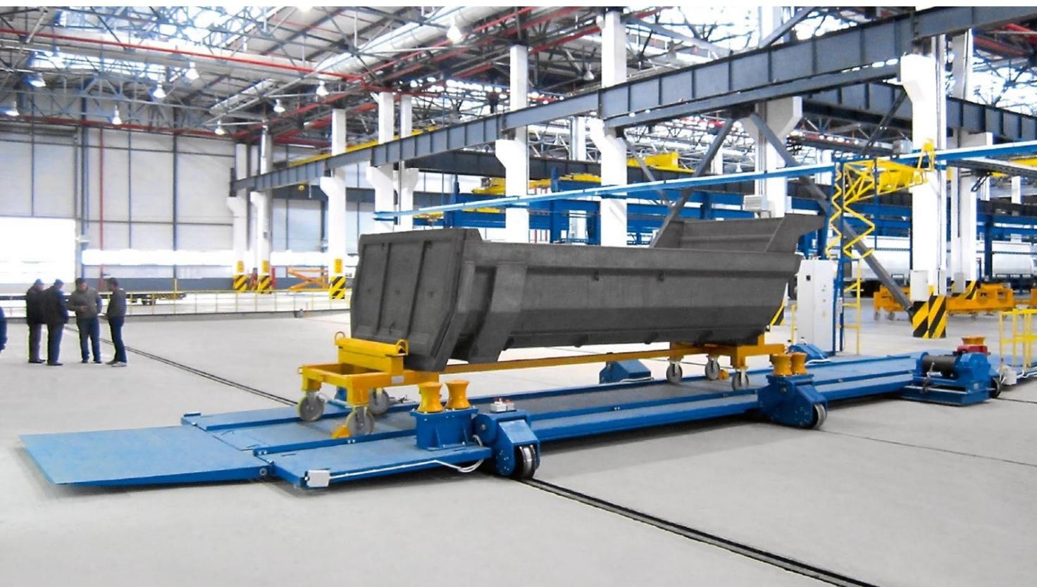
Трансбордерная тележка предназначена для линейного и параллельного перемещения изделий, установленных на технологических тележках, по технологическим позициям. Для обеспечения безопасной работы трансбордер оборудован звуковой и световой сигнализацией.
