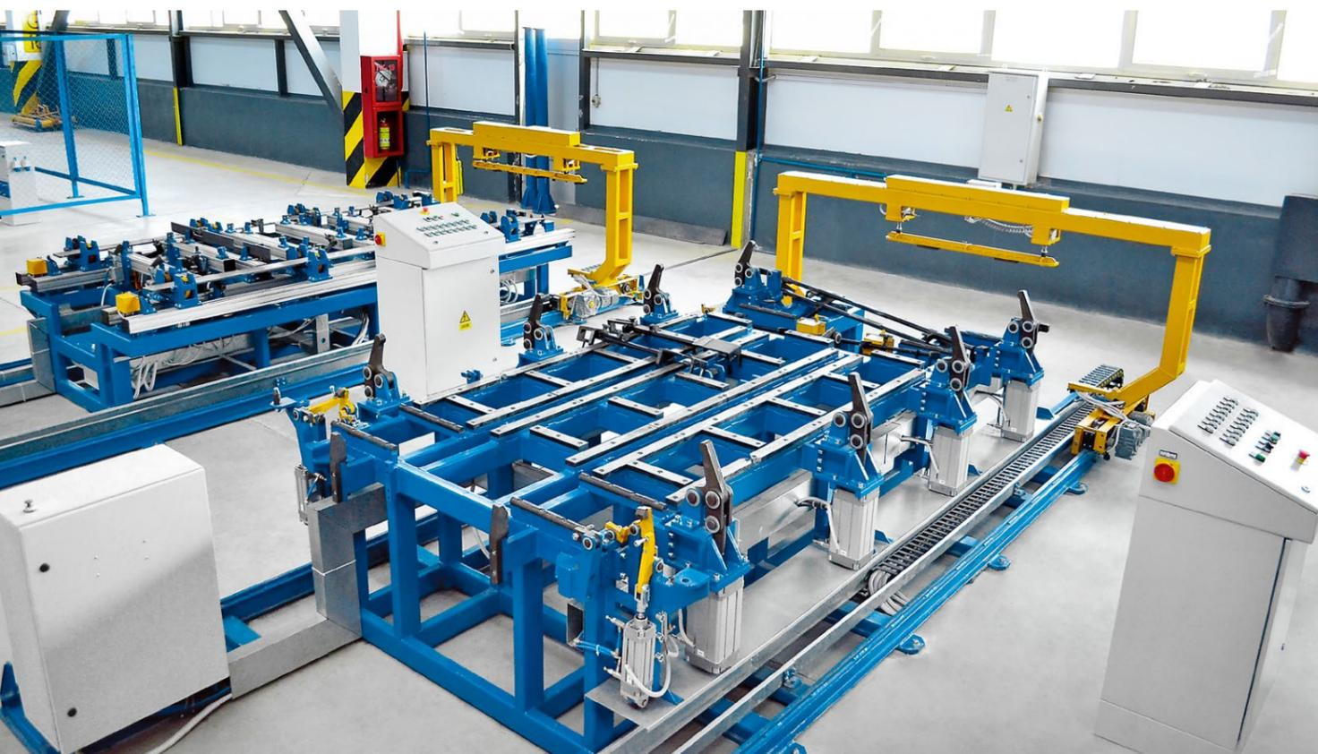
Стенд предназначен для сборки консольной части рам полуприцепов, а также сборки консольной части рамы с настилом пола. Оборудование является универсальным и может выпускать узлы рам 4-х типов полуприцепов. В качестве привода прижимных и базирующих элементов используются пневматические цилиндры.
