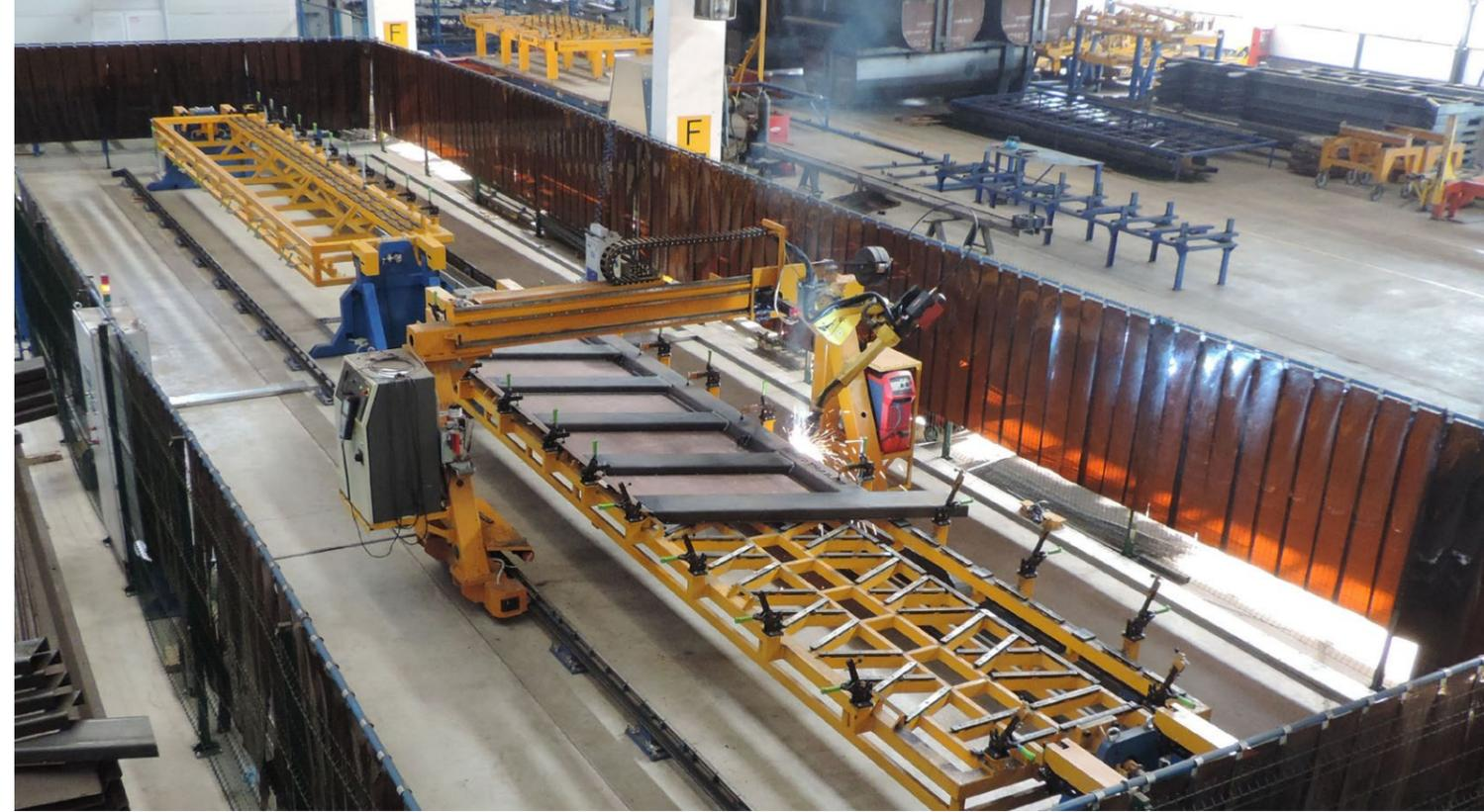
Роботизированный комплекс состоит из двух стандов. На стандах производится сборка и роботизированная сварка левого и правого бортов кузова самосвала.
