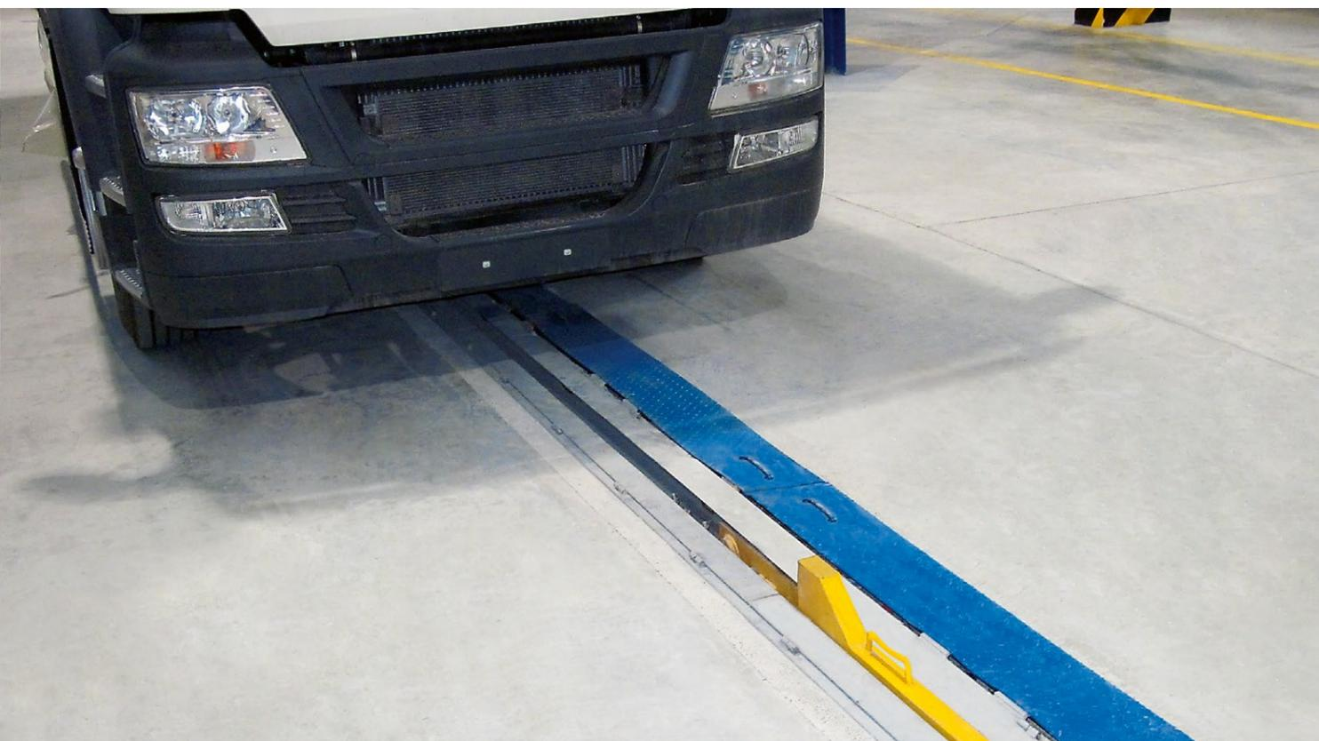
Тяговый конвейер предназначен для транспортирования изделий по технологическим позициям. Конвейер работает в ручном режиме и управляется рабочим с дистанционного пульта управления. За 5 секунд до начала движения конвейера от пусковой кнопки "вперед" включается звуковой сигнал, который выключается вместе с остановкой конвейера.
