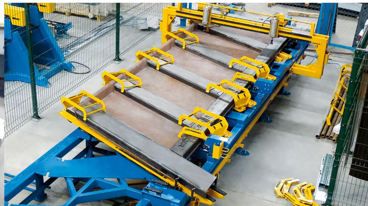
Стенд предназначен для сборки боковин кузова самосвала в нормальном положении. Стенд является универсальным: на нем производится сборка 12 типоразмеров боковых бортов самосвалов. В качестве привода прижимных и базирующих элементов используются пневматические цилиндры. Для фиксации поперечных стоек стенд оснащен катучей балкой с пневмоприжимами.
