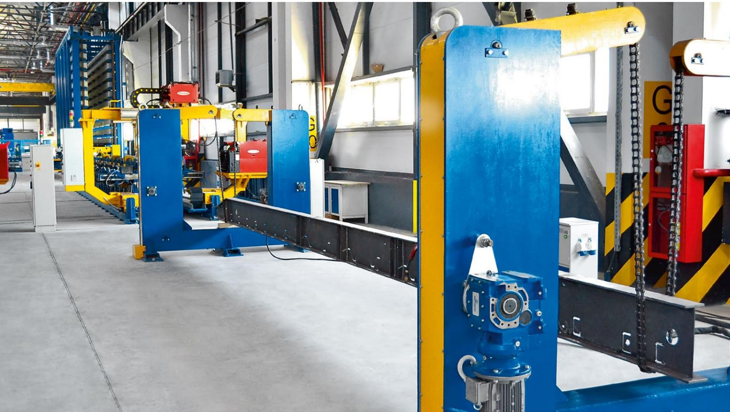
Цепные кантователи предназначены для поворота свариваемого изделия вокруг горизонтальной оси в удобное для сварки положение при полуавтоматической и ручной дуговой сварке.
