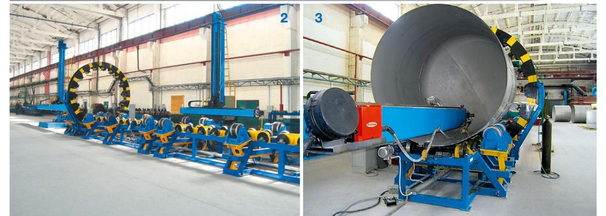
1. Линия сборки и автоматической сварки котлов.
