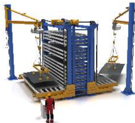
Склад листового металопрокату з двостороннім завантаженням
