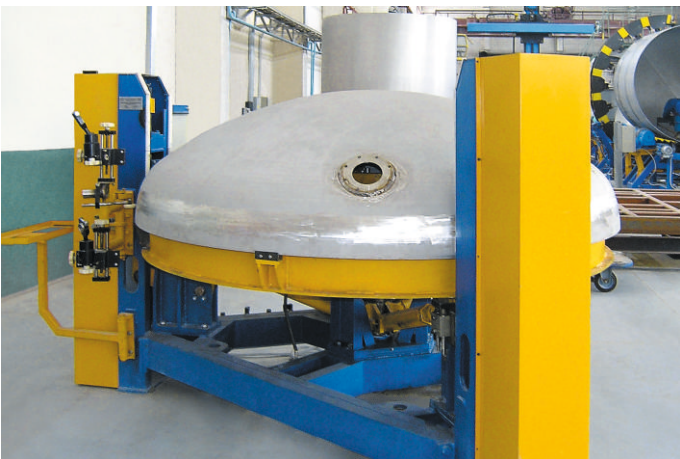
Стенд складання, зварювання днищ котла та торцювання
