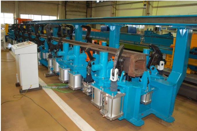
Стенд складання хребтових балок вагоно-цистерн
