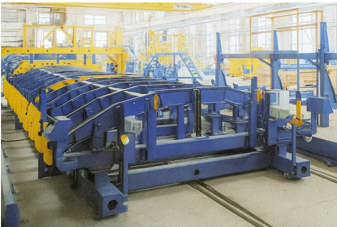
Стенд складання та зварювання даху вагонів-хоперів
