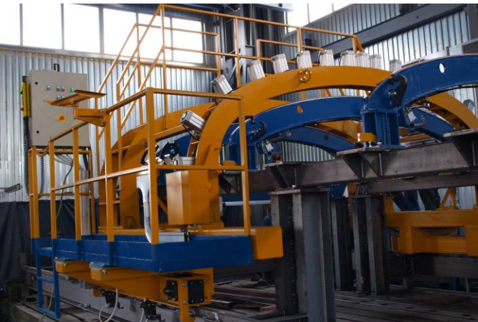
Універсальний стенд складання та зварювання дахів багажних вагонів
