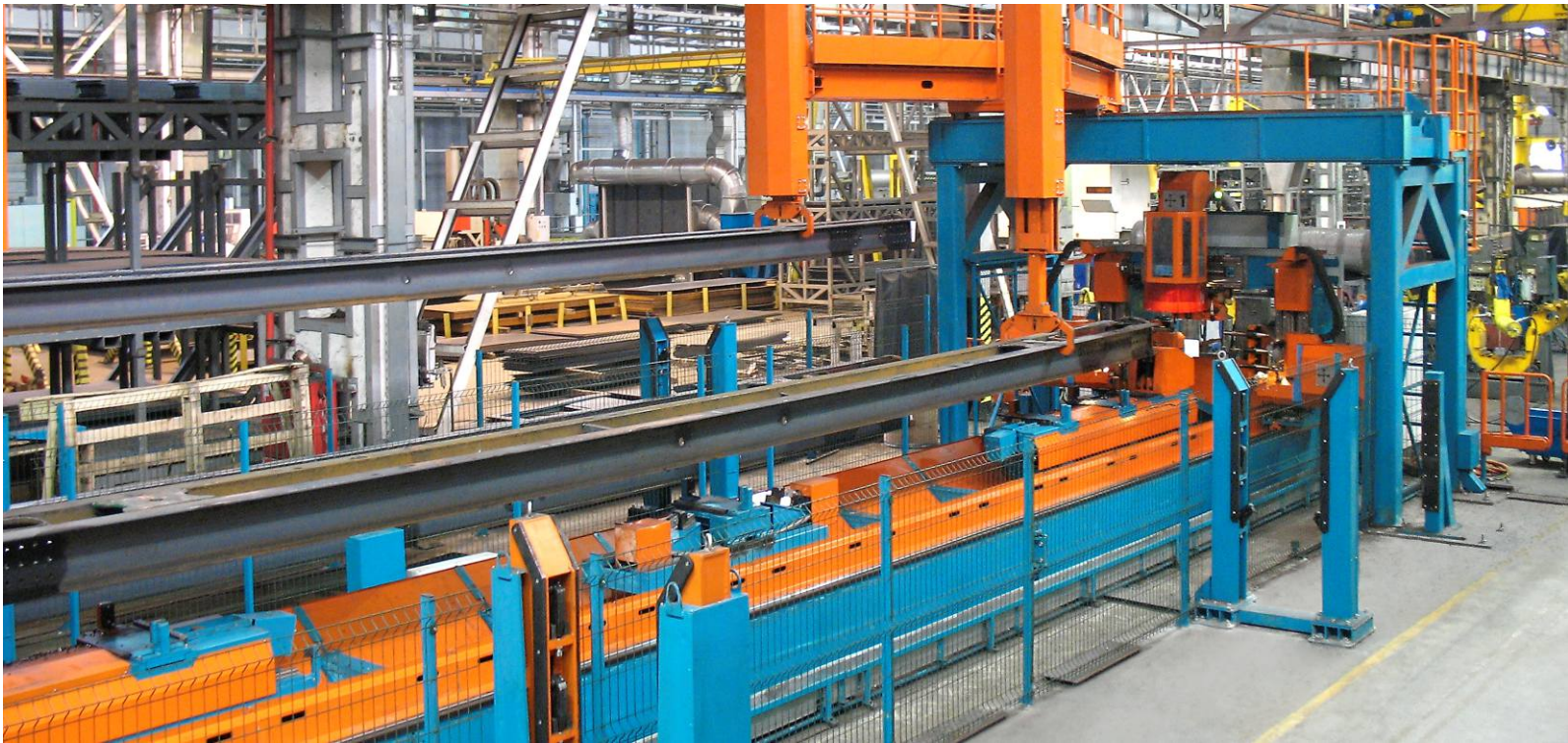
Автоматизований комплекс свердління хребтових балок вантажних вагонів (2 свердлильних портали)
