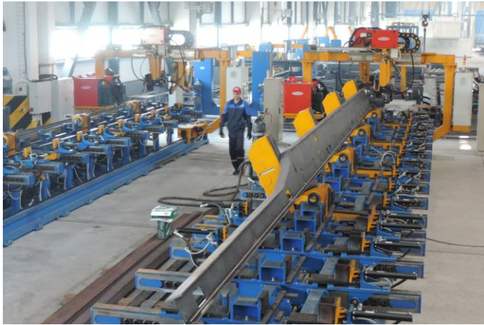
Стенд автоматичного зварювання двотаврових балок змінного перерізу
