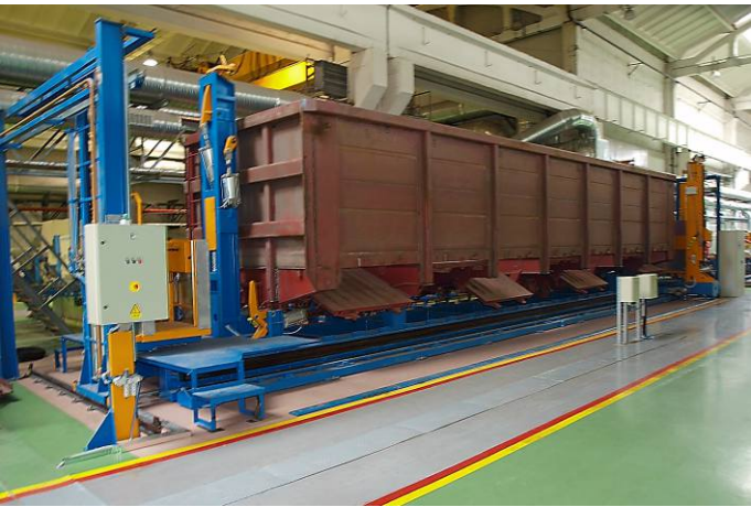
Стенд складання кузовів напіввагонів
