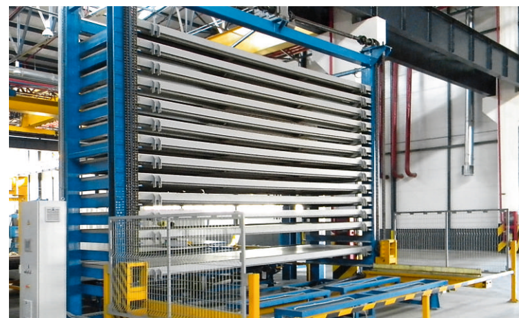
Автоматизований склад листового металопрокату
