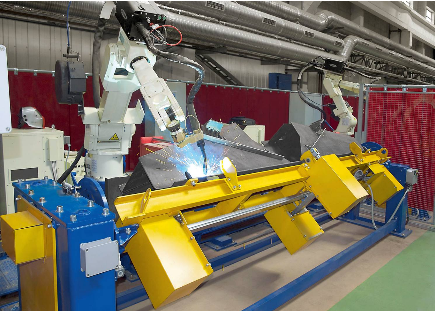
Роботизований комплекс для зварювання перечних балок
