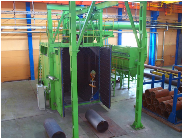
Дробометна установка мод. ДП-1700
