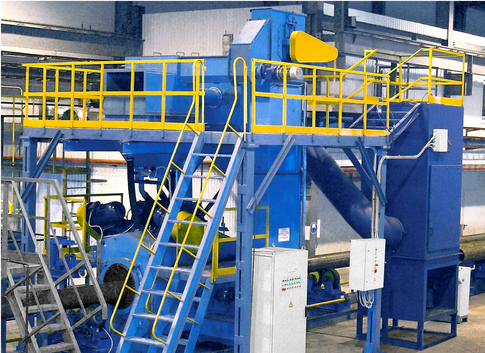
Дробометна камера мод. НТП-630
