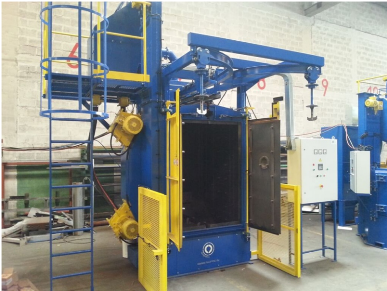
Дробометна установка мод. ДП-1700
