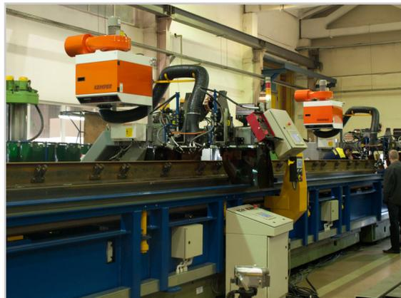
**Рама станда** выполнена в виде жесткой сварной конструкции, на которой смонтированы все элементы станда. Рама оснащена направляющими, обеспечивающими прямолинейное перемещение тележки и одновременно являются базой, обеспечивающей точность установки двутавра относительно оси хребтовой балки. Для компенсации сварочных деформаций, образующихся при приварке двутавра к хребтовой балке, станд оснащен устройством обратного прогиба
