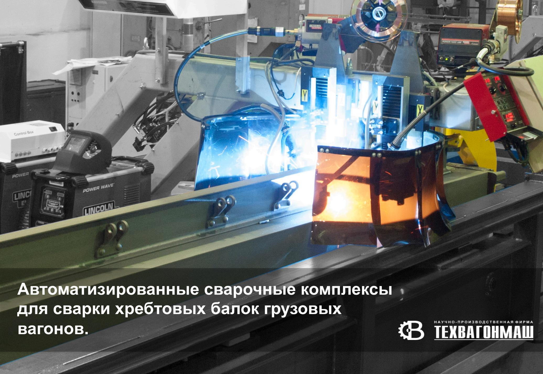
**Автоматизированные сварочные комплексы
