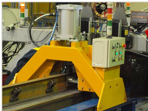
**Сборочная тележка** (портального типа) оснащена боковым и верхним пневматическими прижимами. Перемещаясь вдоль станда, тележка фиксируется в строго определенных местах, производит центровку двутавра и прижим его к хребтовой балке в вертикальной плоскости.
