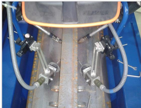
В целях обеспечения точности перемещения сварочных головок относительно оси свариваемого соединения использованы электромеханические датчики тактильного типа Carpano (Италия).
