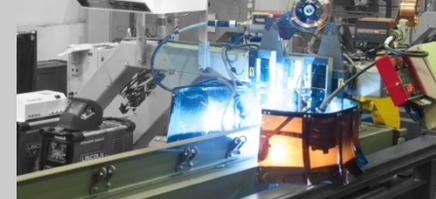
Робото-технический комплекс сварки продольных швов хребтовых балок
