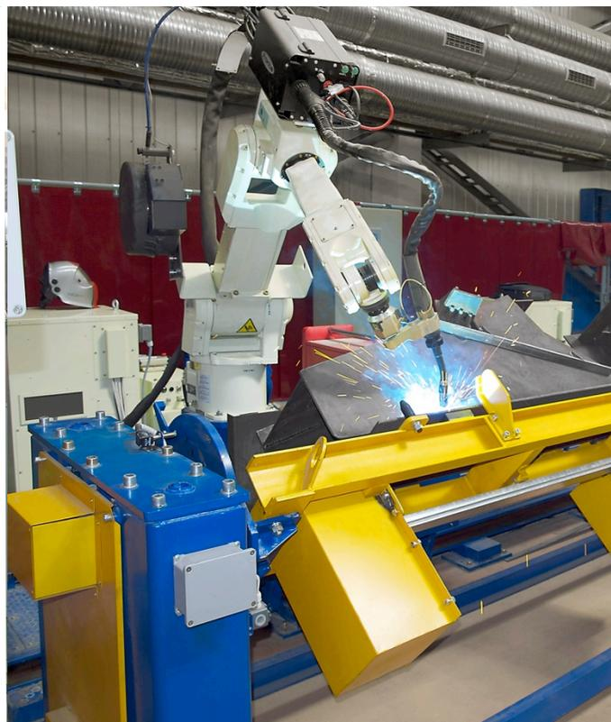
Роботизированные сварочные комплексы
