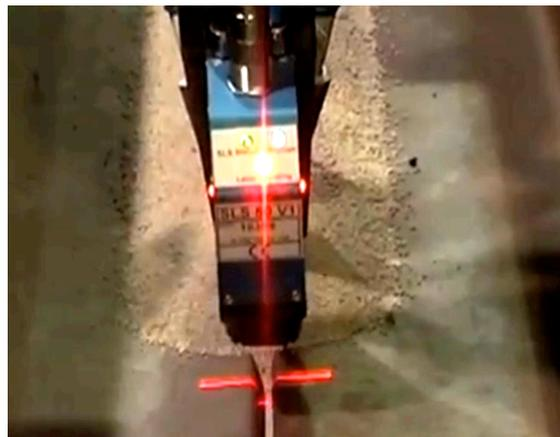
Используемая при сварке **лазерная система слежения Smart Laser Pilot «Meta Vision System»** (Великобритания) предназначена для отслеживания положения оси свариваемого стыка в горизонтальной и вертикальной плоскостях, измерения геометрических параметров стыка и передачи этих данных в контроллер робота для коррекции положения сварочной горелки и параметров режима сварки.
