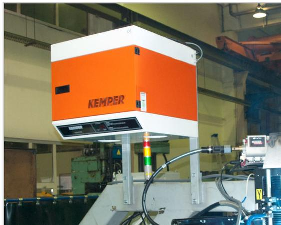
Вентиляционное оборудование предназначено для удаления загрязненного воздуха. Загрязненный воздух удаляется вытяжным устройством, затем попадает в камеру фильтрации грубой очистки для отделения сильных загрязнений, где оседают крупные частицы и далее проходит через взаимосвязанный главный фильтр тонкой очистки со степенью отделимости 99,9 %. Очищенный воздух выбрасывается наружу.
