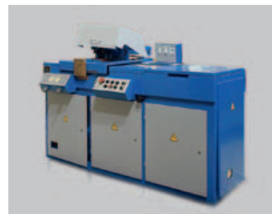
Установка контактной сварки тяг
