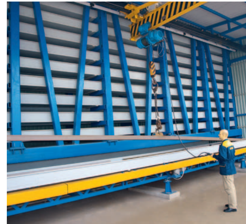
Механизированный склад профильного металлопроката
