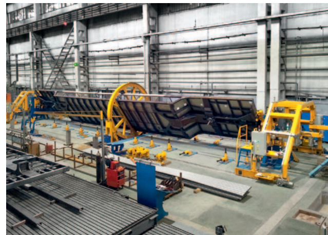
Стенд-кантователь для сварки рам двухэтажных пассажирских вагонов, г/п 10 т
