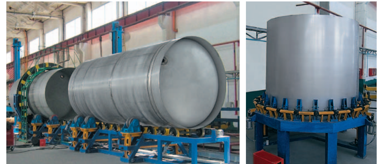
Линия сборки и сварки котла
