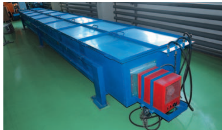
Ванна для испытания труб
