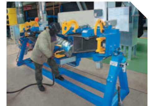
Стенд сборки лобовых балок
