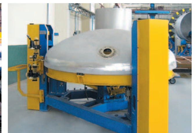
Стенд сборки, сварки днищ котла и торцовки юбки
