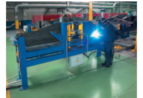
Стенд сборки промежуточных балок
