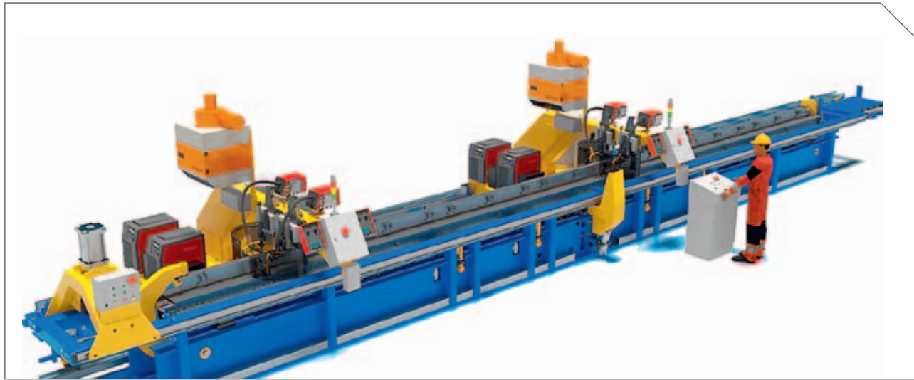
СТЕНД АВТОМАТИЧЕСКОЙ СВАРКИ ХРЕБТОВОЙ БАЛКИ С ДВУТАВРОМ
