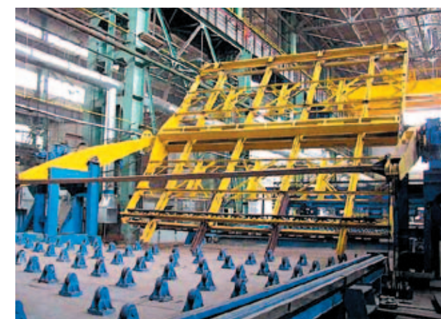
Линия сборки и сварки полотнищ
