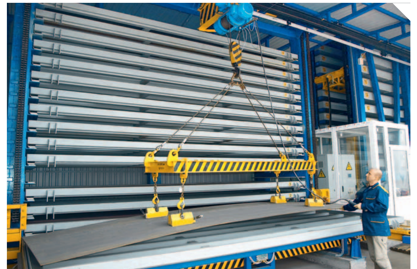
Механизированный склад листового металлопроката
